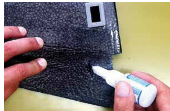
По краям «кабанчика» пропитываем клеем.
