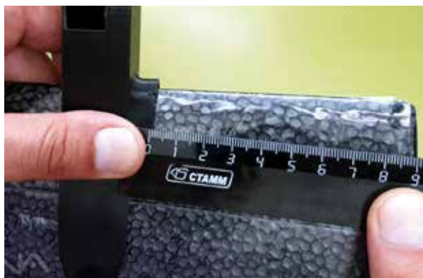
С помощью линейки, отступаем от края 90 мм.
